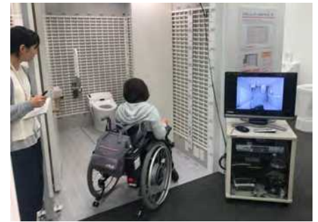
トイレの使い勝手や設備のレイアウトを検討するための車いす使用者による排せつの模擬動作検証と評価 Examination and evaluation of ease of use and layout of equipment of the toilet in a simulated excretion act by a wheelchair user.
