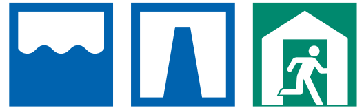
左:「津波注意」国際規格図記号(ISO 20712-1)原型デザイン 上: 洪水関連図記号(JISZ 8210「案内用図記号」(追補1)) left: Prototype design of “Tsunami warning” international standard symbol (ISO 20712-1) top: Graphic symbols for flooding JISZ 8210 “Graphic Symbols for Guiding” (appendix 1)
