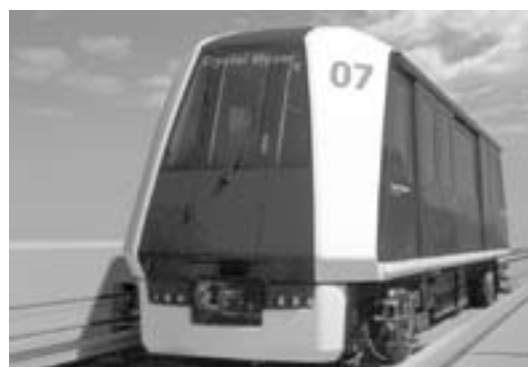
完成車両 / 全長 12.20m、最高速度 80km/h
