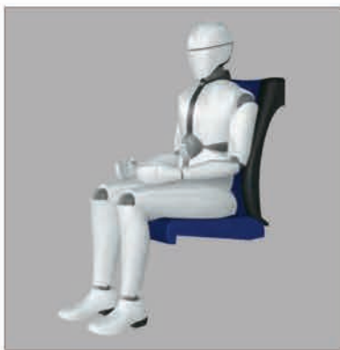
従来の通勤車両シートに比べ、G-Fitは座面だけではなくバックレストの広い面積で荷重を分散して受け止める。 Compared to conventional commuter train seats, G-Fit accepts a load breaking up in a wider area of the seat surface and the backrest.
