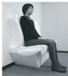
従来の通勤車両シートに比べ、G-Fitは座面だけではなくバックレストの広い面積で荷重を分散して受け止める。 Compared to conventional commuter train seats, G-Fit accepts a load breaking up in a wider area of the seat surface and the backrest.
