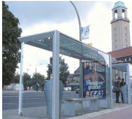
インテリジェントバスストップ／ウォール社（ベルリン） 1999：天面に太陽電池を備え情報端末に電力を供給する。
