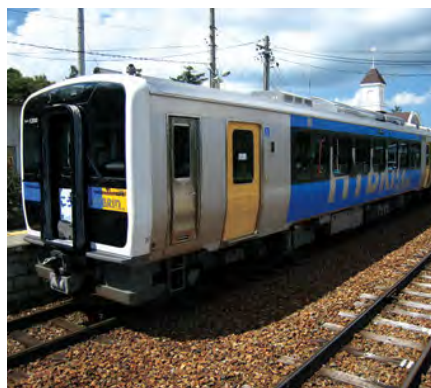
ハイブリッド車両キハE200系／東日本旅客鉄道（株） 2007：小海線に導入された世界初のディーゼルエンジンと電気とのハイブリッド鉄道車両。新たな技術をアピールするグラフィック。
