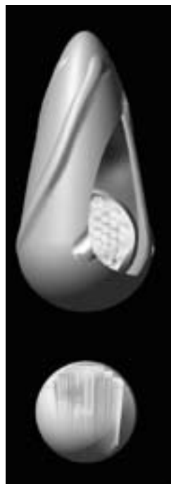
コスモシードの形状。植物の種と同じように、機能に基づいた幾つもの層をもっている。
