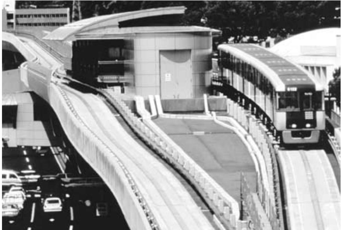
新交通システムは、ゴムタイヤの車両をコンピュータによって運行管理するシステム。写真は広島の主要幹線「アストラムライン」。トータルデザイン計画：デザイン総研広島
